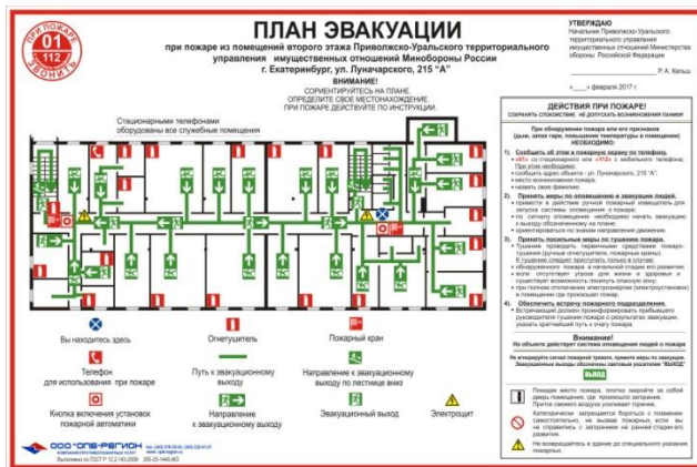
Пример этажного плана эвакуации ГОСТ
